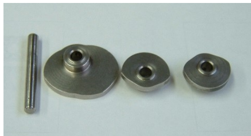
▲ 従来は4つのパーツを組み合わせてカムを構成
